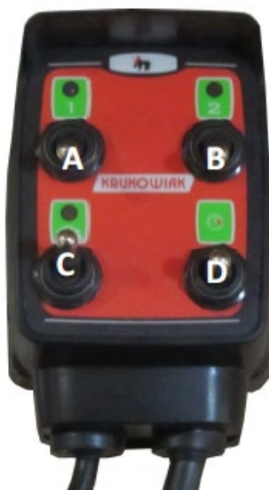
Rysunek 19 Panel sterowania układem cieczowym opryskiwacza.
