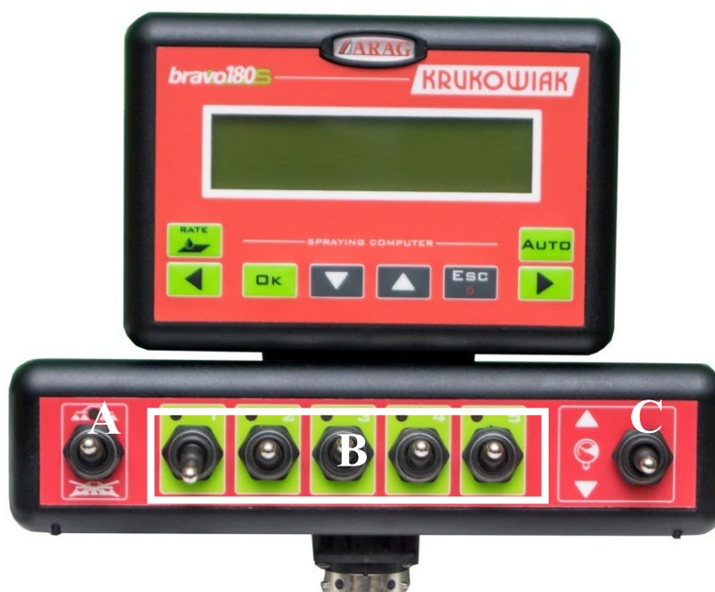
Rysunek 20 Panel sterowania komputera rolniczego Easy 180.
