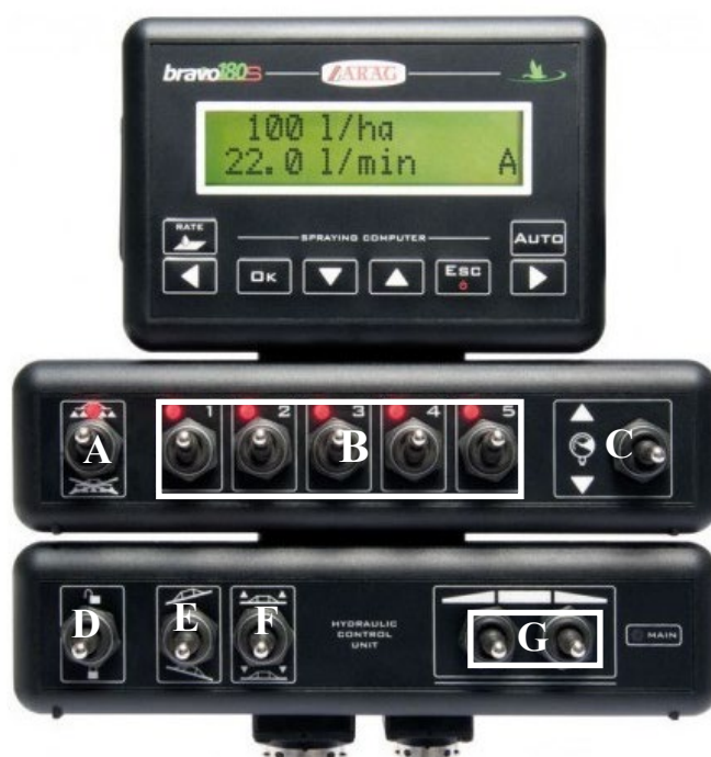
Rysunek 21 Panel sterowania komputera rolniczego Easy 180 + hydraulika.
